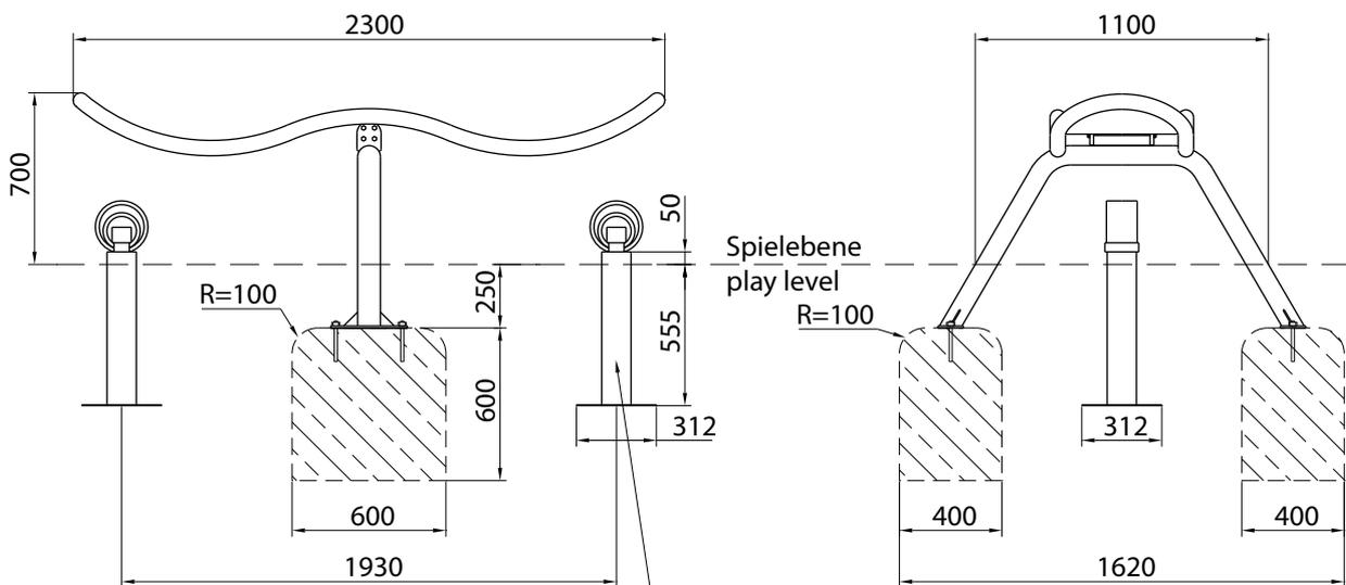
Bei lockerem Boden einbetonieren
