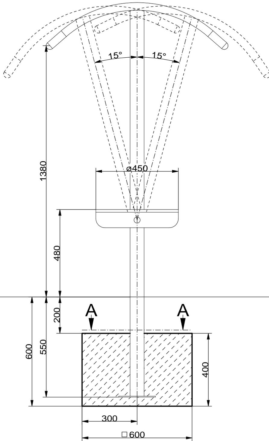
**Schnitt A-A Fundament M1:25**
